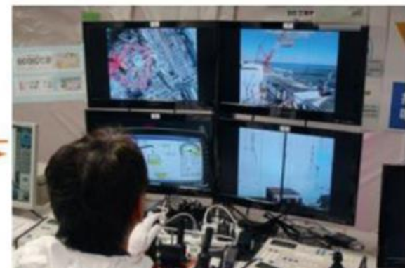
現場から500m離れた遠隔操作室。写真はクローラークレーンを操作する様子
