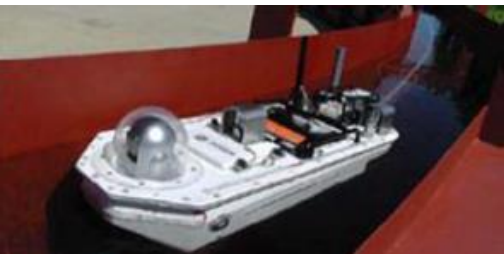
S/C内周側調査 水上ポート
