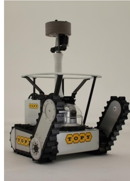
トラス室内調査装置
