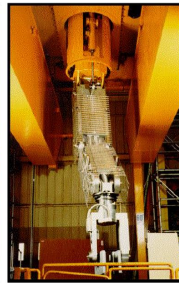
ATENA-RD500タイプの遠隔マニピュレータを備える多関節ホルダー
