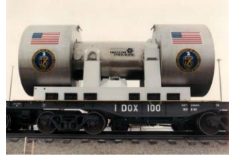
鉄道輸送用キャスク1基につき7 キャニスター、 1回の出荷で最大3キャスク
