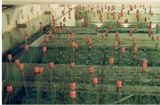
1986年から2001年まで INL TAN施設内 使用済燃料貯蔵 プールでの湿式貯蔵
